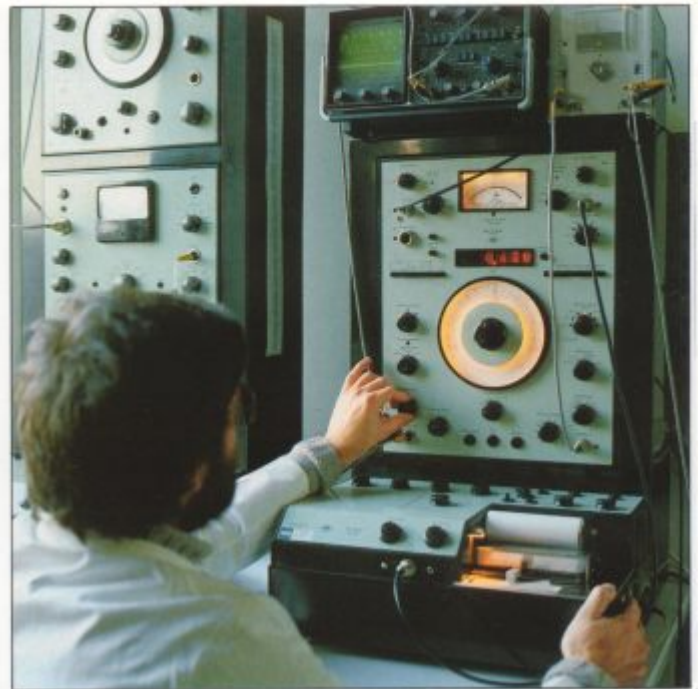
Untersuchung der Trommelschwingungsformen: Sinus-generator zur Anregung der Trommelschwingungen. Links im Bild Terz-Analysator zur Messung der Ausklangzeiten.
