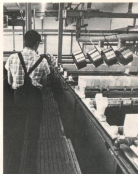
zur Verchromung. In dieser Halle standen 2 Reihen von verschiedenen Wannen zum Waschen, Eloxieren und Verchromen. Vor dem Verchromen wird jedes Teil mit Halbautomaten oder von Hand poliert. Dann werden die Teile auf Gestänge gesteckt oder gehängt. In bestimmten Zeitintervallen werden dann die Teile in die Wannen zum Säubern, Vernickeln, Verkupfern und Verchromen gehängt. Anschließend werden alle Teile wieder poliert.
