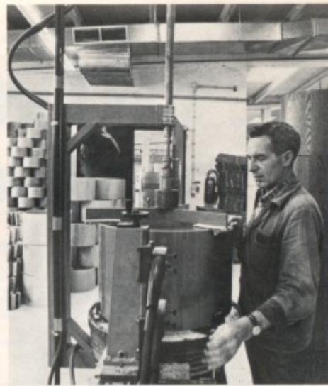
Eine Maschine für Kesselbohrungen
